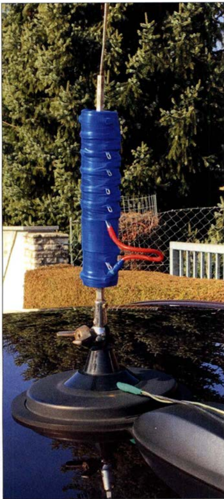
Bild 11: Wetterfest ausgeführte Verlängerungsspule der Mobilantenne; hier im fertig montierten Zustand auf dem Autodach
