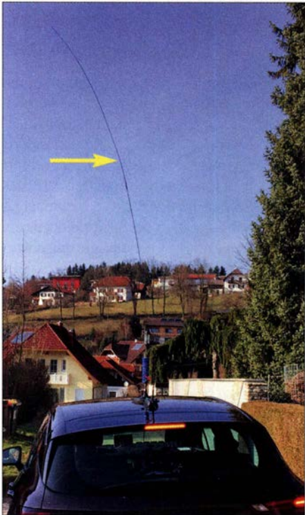
Bild 1: Die selbst gebaute Mobilantenne (hier auf dem Fahrzeugdach montiert) ist schmal und leicht. Dadurch bietet sie nur eine geringe Windlast. Fotos: OE5SMU
