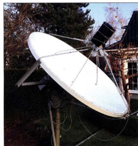
Das ist die 24-GHz-Antenne mit montiertem 24-GHz-Kopf inklusive 40-45 W TWTA und (!) dem dazugehörigen RWN-Hochspannungsnetzteil; alles unter dem wasserdichten Wetterschutz im Fokuspunkt hinter dem vertikal polarisierten Feed. Foto: DL7YC
