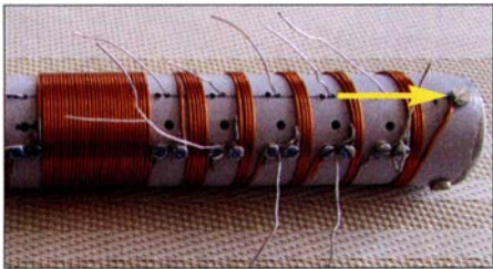
Bild 4: Kontaktschraube zur sicheren elektrischen Verbindung zwischen Spule und Strahler
