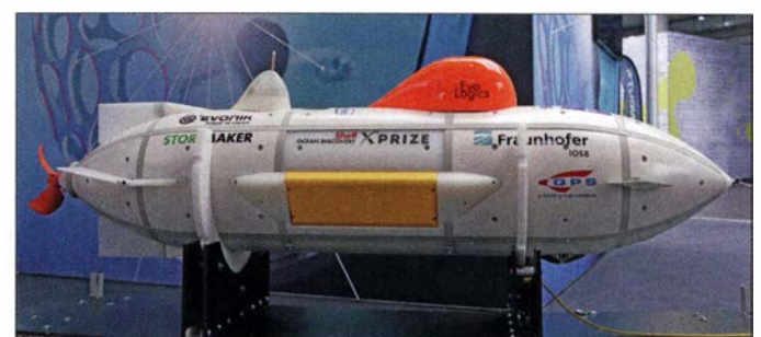
Die Tauchdrohne Great Diver des Fraunhofer IOSB soll Kosten für die Tiefseeforschung reduzieren.
