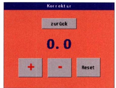
Bild 5: Pegelkorrektur eingabe. Die Pegelkorrektur eingabe ist auf der dritten Displayseite mittels Button +/- möglich.
