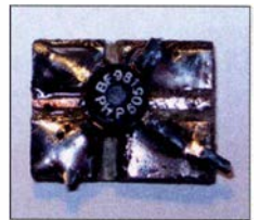
Bild 3: Leiterplattenstück mit vier Lötspots für einen BF981
