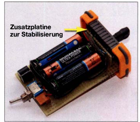
Bild 4: Oberseite der bestückten Leiterplatte mit Summer, Schalter und Batterien
