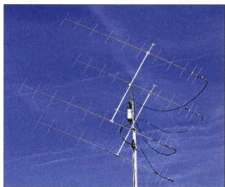
Mit seinen vier 11/11-Element-Kreuzyagi-Antennen ist DK5YA auch bei EME gut präpariert: Polarisationsdrehungen des empfangenen Signals behindern nicht, wenn man in beiden Ebenen empfangen und senden kann. Foto: DK5YA
