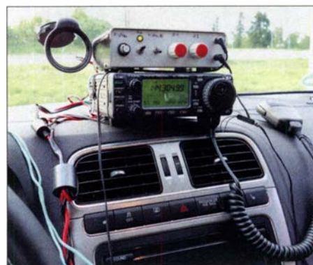
Bild 2: Für den Portabelbetrieb ist eine Stromversorgung aus Akkumulatoren nahezu unverzichtbar.
