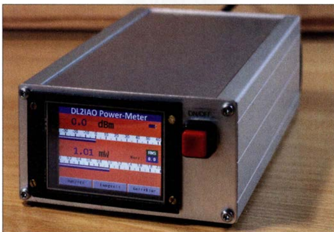
Bild 1: Selbst gebautes HF-Wattmeter mit Nextion-Grafikdisplay; abgesehen vom Hauptschalter gibt es keine weiteren mechanischen Bedienelemente, da alle Eingabefunktionen über das Touch-Display realisiert werden.
