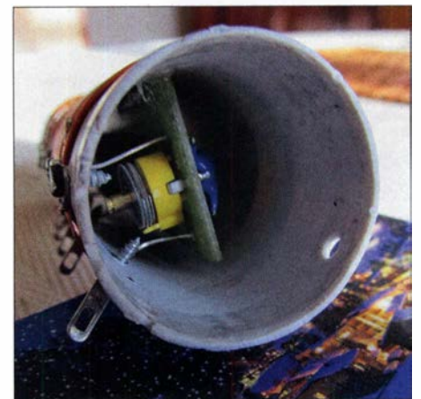
Bild 10: Die Trägerplatte mit den Festkondensatoren und Trimmern wird mit Klebstoff im Innern des Spulenkörpers befestigt.
