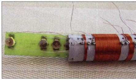
Bild 7: Das Einziehen und Verdrachten der Kondensatorplatine geschieht schrittweise, wie im Text beschrieben.
