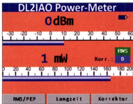
Bild 3: Hauptseite des Grafikdisplays mit Touchscreen-Funktion (die Anzeigespeicher sind hier noch mit zufälligen Werten gefüllt).
