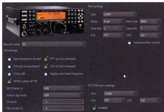
Set-up-Menü: Transceiver von Elecraft, Icom, JRC, Kenwood, TenTec und Yaesu werden CAT-seitig unterstützt.
